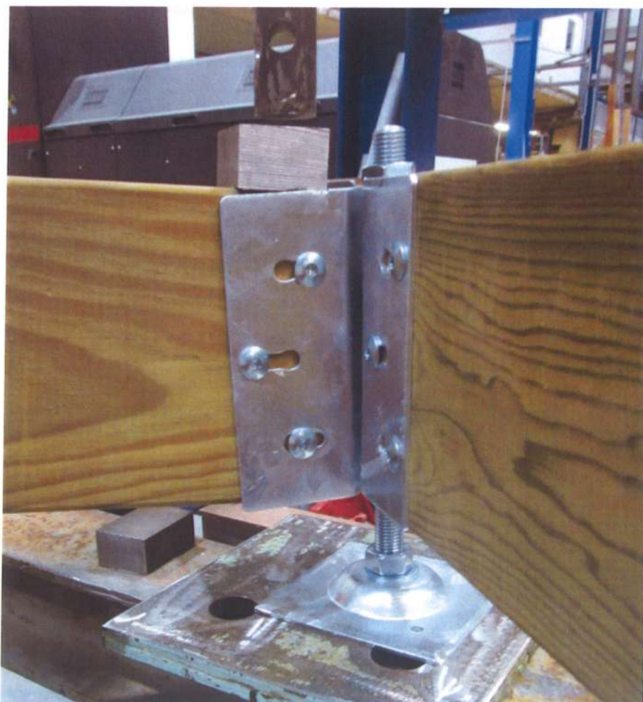
Eprouvette BMA6-M-4001/4 : Vue de la déformation observée
