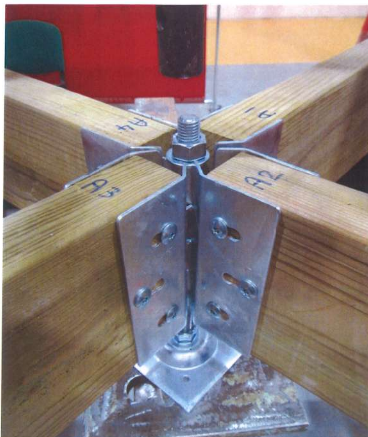
Eprouvette BMA6-M-4001/1 : Détail de l'assemblage central
